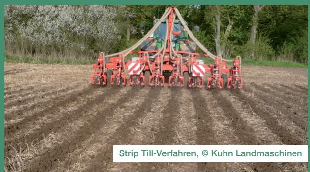
Strip Till-Verfahren, © Kuhn Landmaschinen
